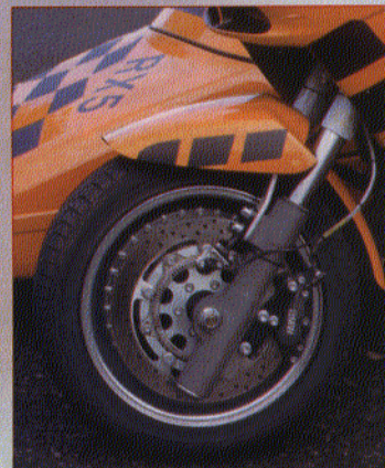
Massive Radführung: Gespann-Telegabel von Reiger
